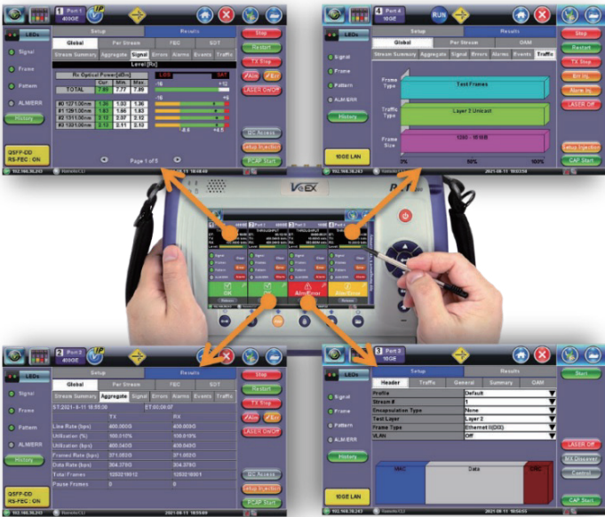
QSFP-DD 2ポートを含む最大4ポート同時テストが可能
