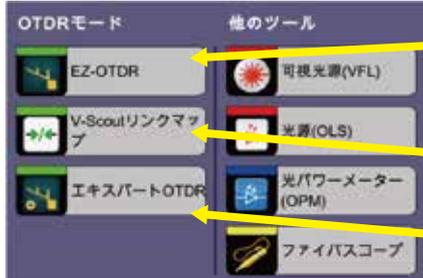
自動で最適な距離レンジやパルス幅を設定し、総距離や総損失を求める
