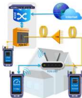
ONUへ有線/無線接続をして速度試験を実施
